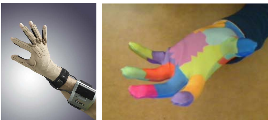
Figur 5: Vänster: Datahandske (VR realities Cyber Glove II); höger: mönstrad latexhandske för optisk hand-tracking (Wang & Popovic, 2009).
