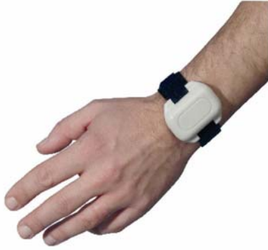
Fig. 1 Sändare för passiv alarmering från Athena Nordic.
