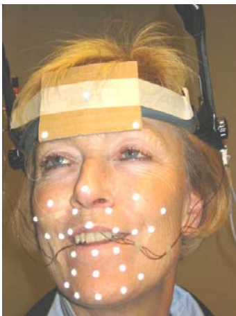
Figur 3. Utrustning för att mäta ansiktets och tungans rörelser. De vita reflekterande markörerna i vänstra bilden följs i tre dimensioner av infraröda kameror. Huvudställningen håller två elektromagnetiska sändare (utanför bild) som genererar ett magnetiskt fält inuti de sensorer som placeras på tungan och framtänderna. Den högra bilden visar sensorernas placering.
